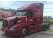
L’IVI n’est pas en mesure de recommander le remplacement de l’entièreté des activités du camion 5095 par un véhicule électrique en ce moment. Compléter tous les trajets d’une journée sans recharger au dépôt requiert une batterie munie d’une énergie plus grande que celles présentement offertes sur le marché.
